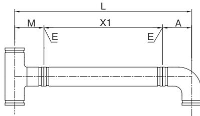
現場加工のパイプ切断寸法の求め方は次式の通りです。
